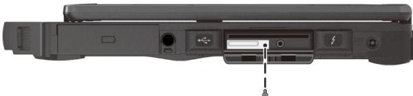
4. 将 SIM 卡插入插槽。方向为卡上的金属触点区域朝上，斜角朝内。
