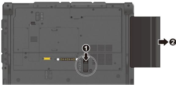
5. 以正确方向性将要安装的组件插入到就定位。硬盘门闩应该自动弹入锁定位
