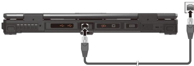
特定型号有第二个 LAN 模块（LAN2），让您可以同时连接两个网络。
