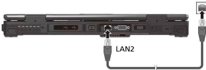
**注：** LAN2 模块支持 DSM (Deep Slumber Mode)，通过 LAN 模块只在网络线已接上时用电来节省电池电力。在这个机制下，当网络线未接上时，Windows 的设备管理器并不会出现此 LAN2 设备；网络线接上时才会出现。
